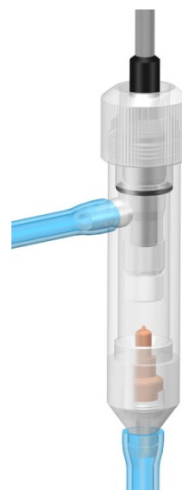
Рис.3.2. Внешний вид сенсора в измерительной камере.
