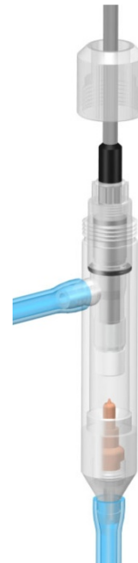
Рис. 3.10. Фиксация АСрО 2 в измерительной камере
