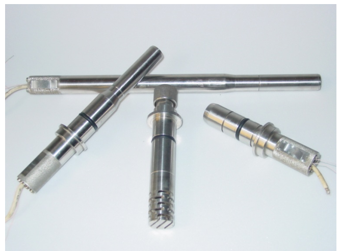
Рис. 3.6. Внешний вид стерилизуемых амперометрических сенсоров ACSrO 2 -06.
